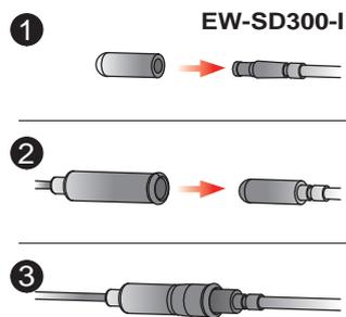
67R2 Di2 EW-SD300-I 電線專用連結膠套，需搭配 67R1 使用
